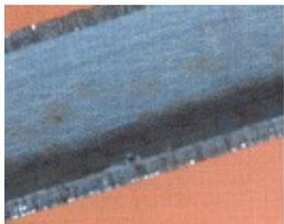
Strato protettivo di  $\gamma\text{-Fe}_2\text{O}_3$  in un tubo di acciaio
